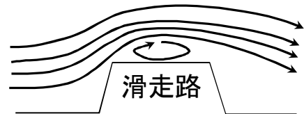
図10 台形状の滑走路に発生する乱流の概念図
