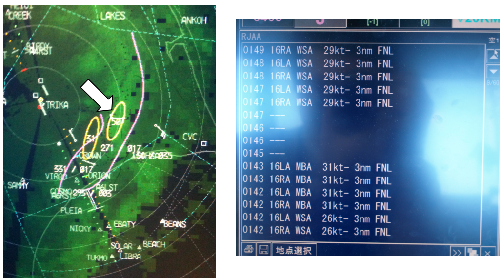
図 14 管制卓に表示されるマイクロバーストやシアアラインの表示例 (左図)
